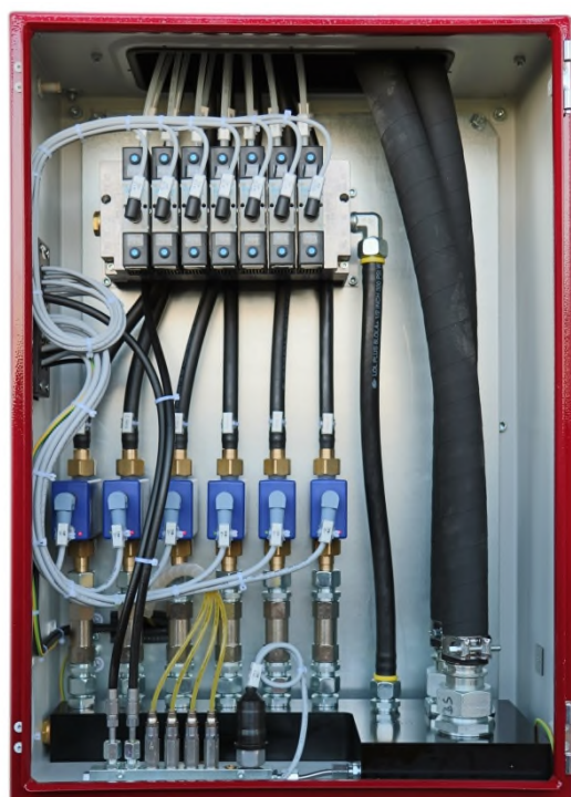
Abb.: Trennstoffmengenerfassung für 6 Sprühkreise integriert in Formsprühanlage
