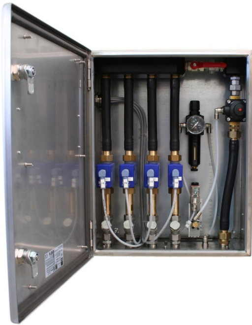
imagen: supervisión de la capacidad del flujo (unidad separada) con control Siemens para 4 circuitos de lubricante
