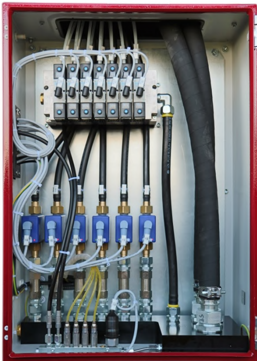
imagen: supervisión de la capacidad del flujo para 6 circuitos de lubricante integrado en sistemas de pulverización
